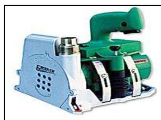
**10.6.** La profondeur de la rainure **doit être ajustée pour** correspondre au support en jute.
